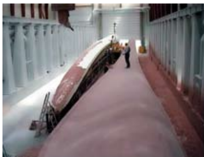
Foto: Einsatz eines Großbearbeitungszentrums im Rotorblatt-Formenbau
